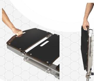
Para a seção do dorso, cabeceira, quadril e perneira bipartida, em toda a sua extensão não há metais ou réguas de encaixe, mantendo todo o tampo 100% radiotransparente. **Além disso, permite a inversão de paciente, permitindo o encaixe entre placa de cabeça e placa das pernas, sendo intercambiáveis, mantendo a possibilidade de abertura (giro) das pernas para o acesso do cirurgião.**
